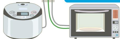
電気炊飯器10A(1,000W)と電子レンジ12A(1,200W)を同時に使用すると合計で22A(2,200W)となり、配線用遮断器の容量20A(2,000W)を超えるので配線用遮断器が作動して、電気を止めます。
