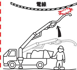
責任者は現場の上空に送電線があることを知っていたが、短時間で終わるため電力会社に連絡をしなかった。作業が終わりポンプ車のホースに残ったコンクリートを掃除するため、ジブを立てた時、電線に接近、作業員が感電、負傷した。また154kVの送電線が1時間停電した。
